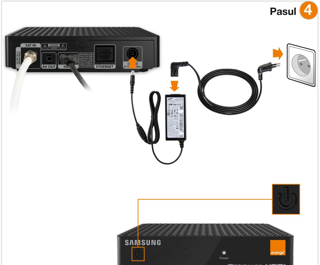
Conectează receiverul la priza electrică, apoi apasă butonul on/off aflat pe fața receiverului.
