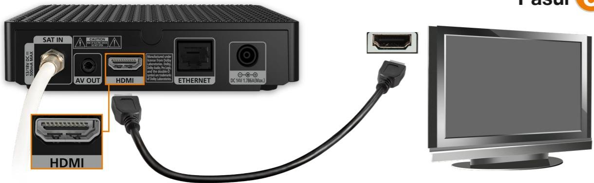
Conectează cablul HDMI de la televizor la ieșirea HDMI a receiverului.
