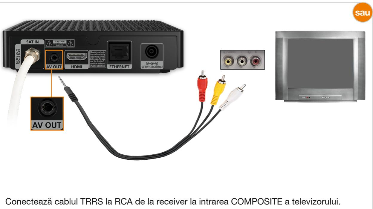
Conectează cablul TRRS la RCA de la receiver la intrarea COMPOSITE a televizorului.
